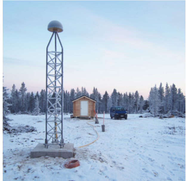
Masto ja GNSS Choken Ring -antenni, jolla erilaisia paikannussignaaleja vastaanotetaan.
